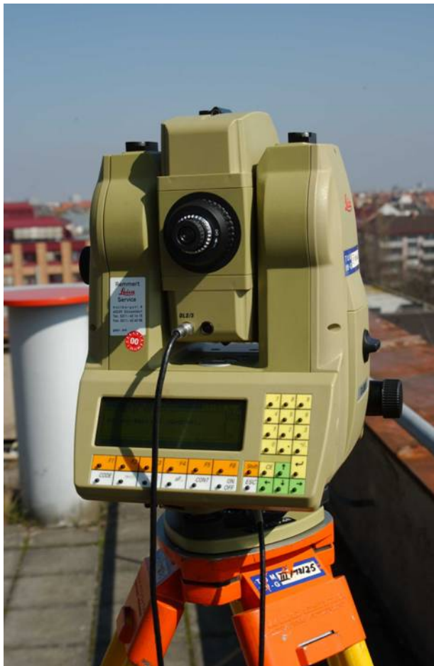
Illustration 13: tachéomètre à interface avec la caméra ATR
