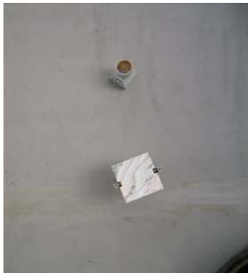
Illustration 11 : miroir plan destiné à rediriger le rayon sur un point caché
